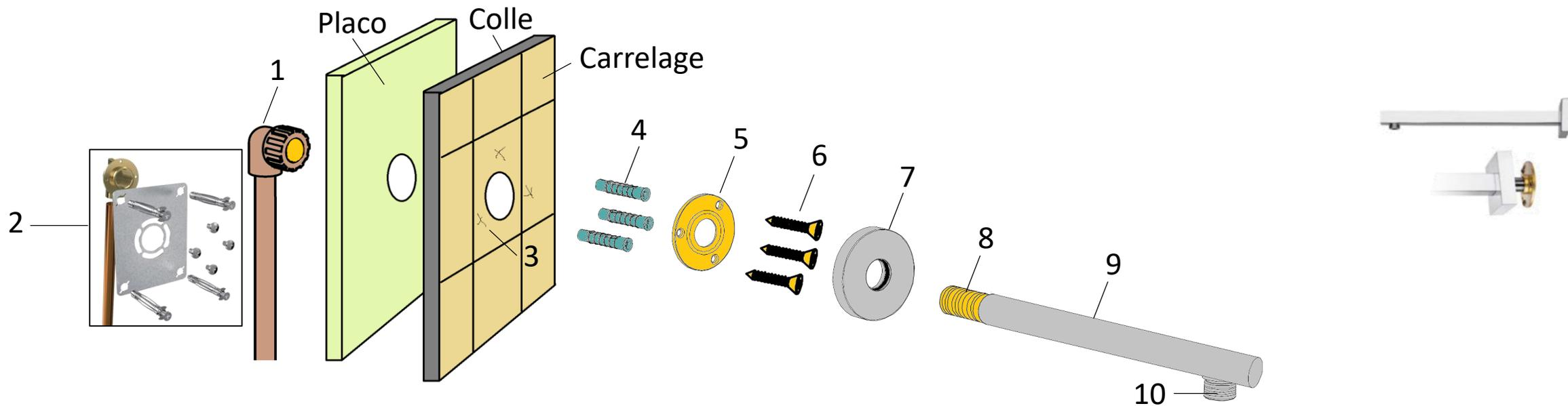
Préparer son raccordement de plomberie (1), l'alimentation doit arriver dans le mur en femelle ½.
