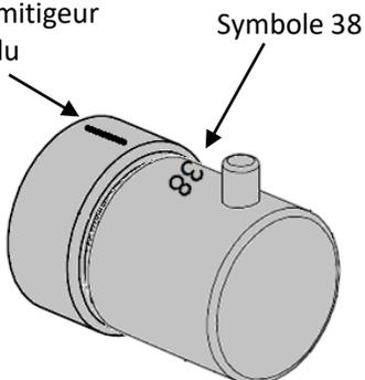
La manette doit se retrouver à la fin avec le symbole 38 à l'axe du mitigeur, ou face au repère sur le corps du mitigeur lorsqu'il y en a un.
