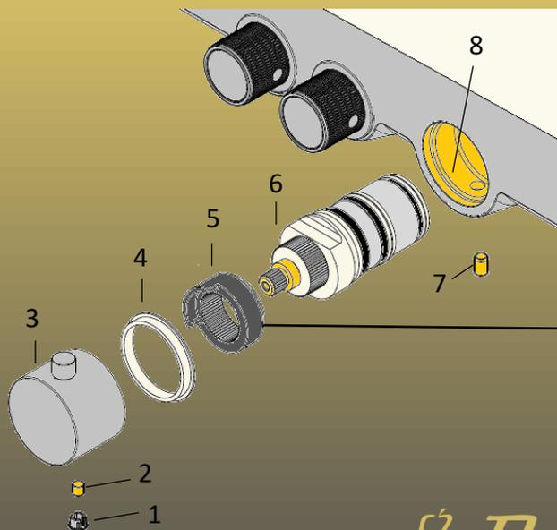
Pour remettre la bague de sécurité (5) la positionner comme ci-dessous
